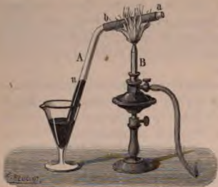
Fig. 77. — Analyse de l'acide sulfhydrique par l'étain.
